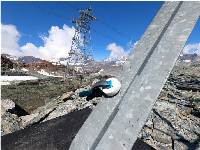
**Bild 10:** Messaufbau mit Kontaktmikrofon am Seilbahnmast der alten Seilbahn von Zermatt Trockener Steg aufs Klein Matterhorn<sup>15</sup>.
